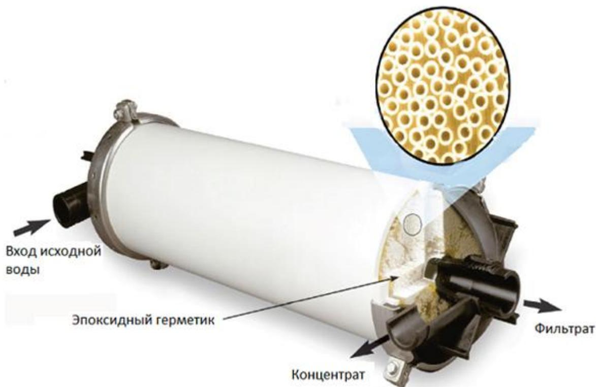
**Рис.9.** Ультрафильтрационный элемент HYDRAcap
