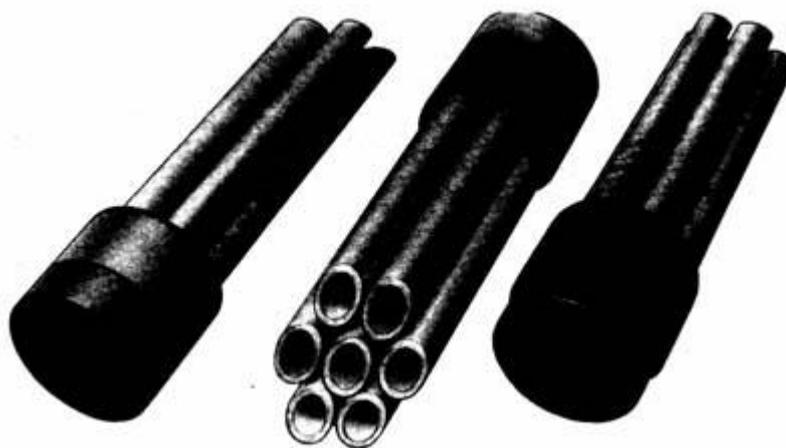
**Рис. 9.17** Фильтрующий элемент БТУ–0,5/2.
