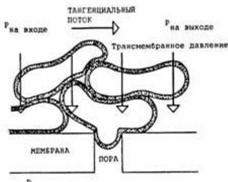
Рис. 9.3 Схема деформации клеток в порах микрофльтрационной мембраны
