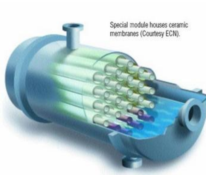
Рис.2.5.4. Первопарационный модуль на основе трубчатых керамических мембран.
