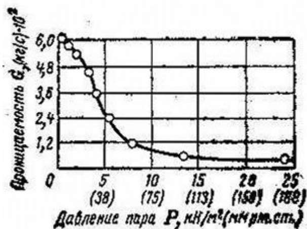
Рис. 2.7.14. Зависимости скорости проникания воды через целлофан от давления воздуха в системе на выходе после мембраны.
