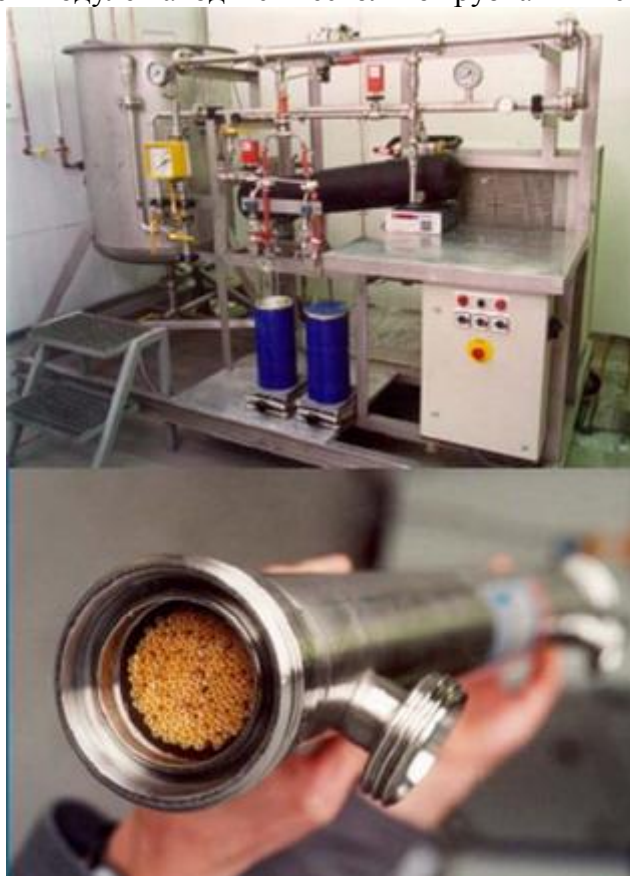
Рис. 2.5.5. Установка гидрофобной первапорации с полволоконными мембранными модулями.
