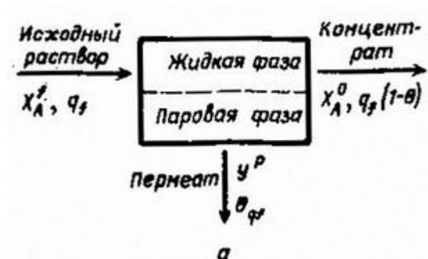
Рис. 2.8.1. Схема потоков при идеальном перемешивании в жидкой фазе.
