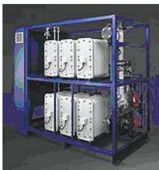
Рис. 4.7. Внешний вид электромембранного модуля фильтр-прессного типа и установки, состоящей из модулей этого типа.
